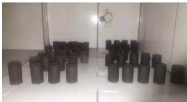
Figura 16 – Corpos de prova aguardando 7 dias para cura a frio.
