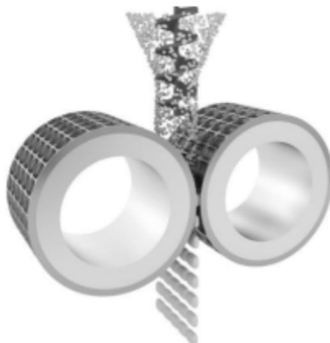
Figura 3 – Princípio da compressão em prensas de rolo
