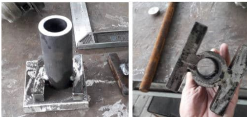
Figura 15 – Vista de frente e interna dos moldes de corpo de prova
