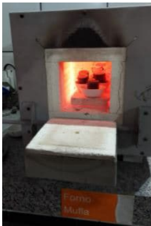
Figura 17 – Posicionamento dos corpos de prova no forno mufla a 1000°C.
