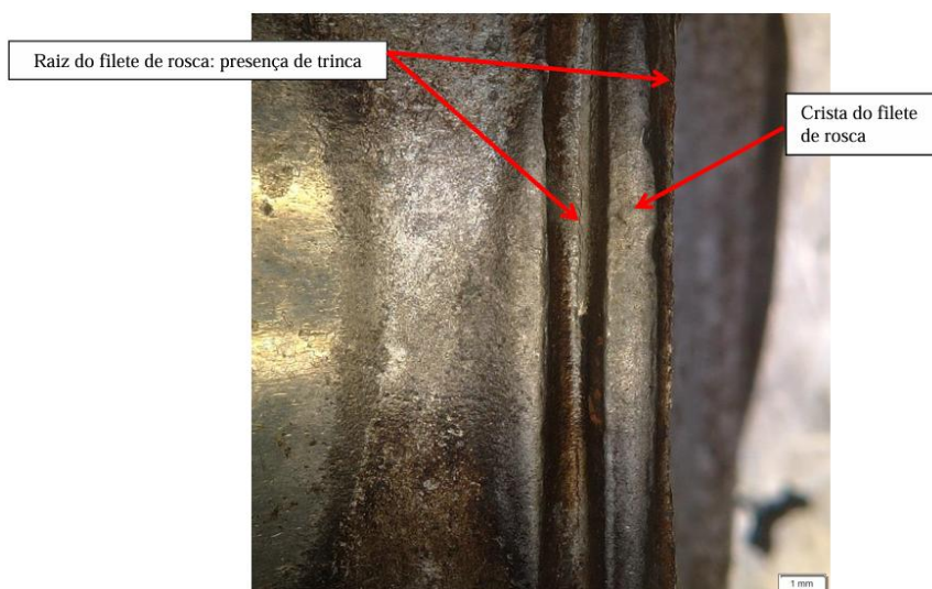
Figura 29: Superfície lateral da fratura – Parafuso fraturado 2 Fonte: Pesquisa direta (2025)
