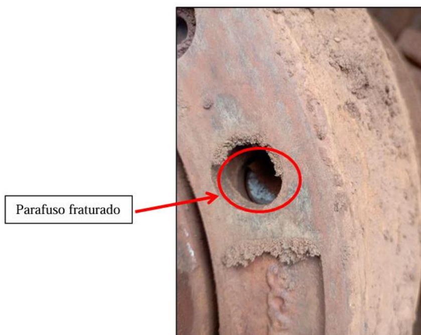
Figura 12: Parafuso fraturado na roda que soltou Fonte: Pesquisa direta (2025)
