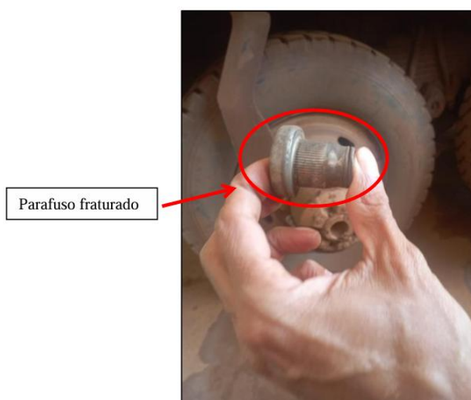
Figura 13: Parafuso de roda fraturado Fonte: Pesquisa direta (2025)
