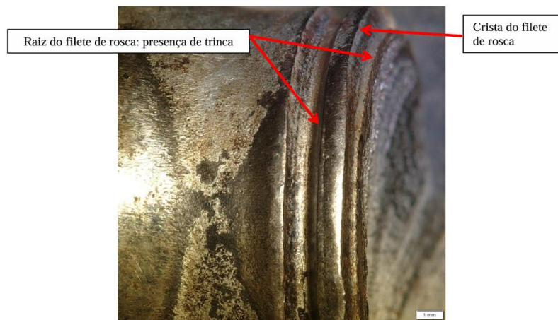
Figura 27: Superfície lateral – parafuso fraturado 1 Fonte: Pesquisa direta (2025)
