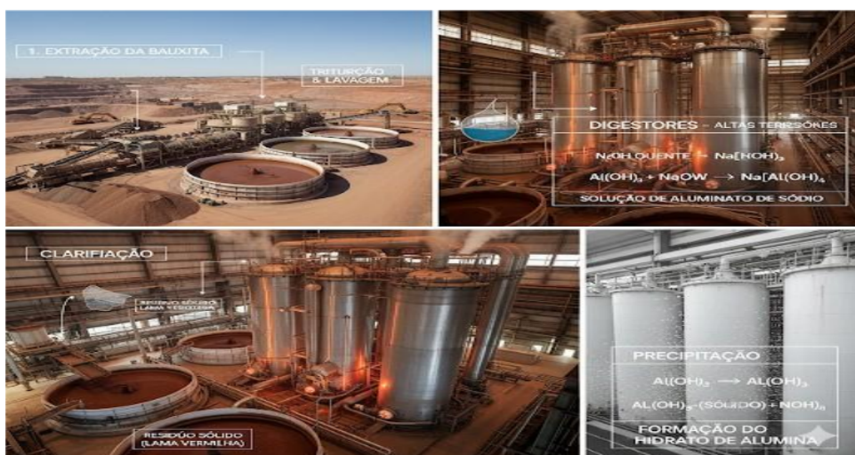
Figura 1 – Visão Geral do Processo Bayer
