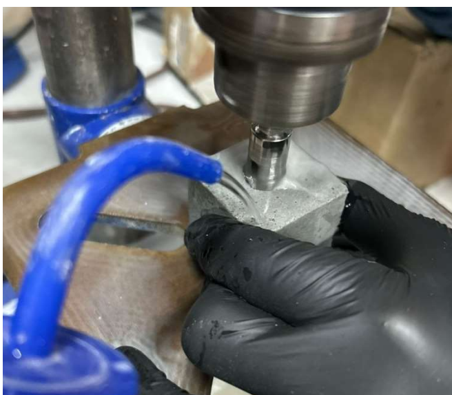
Figura 10: Extração de amostra para realização de MCT
