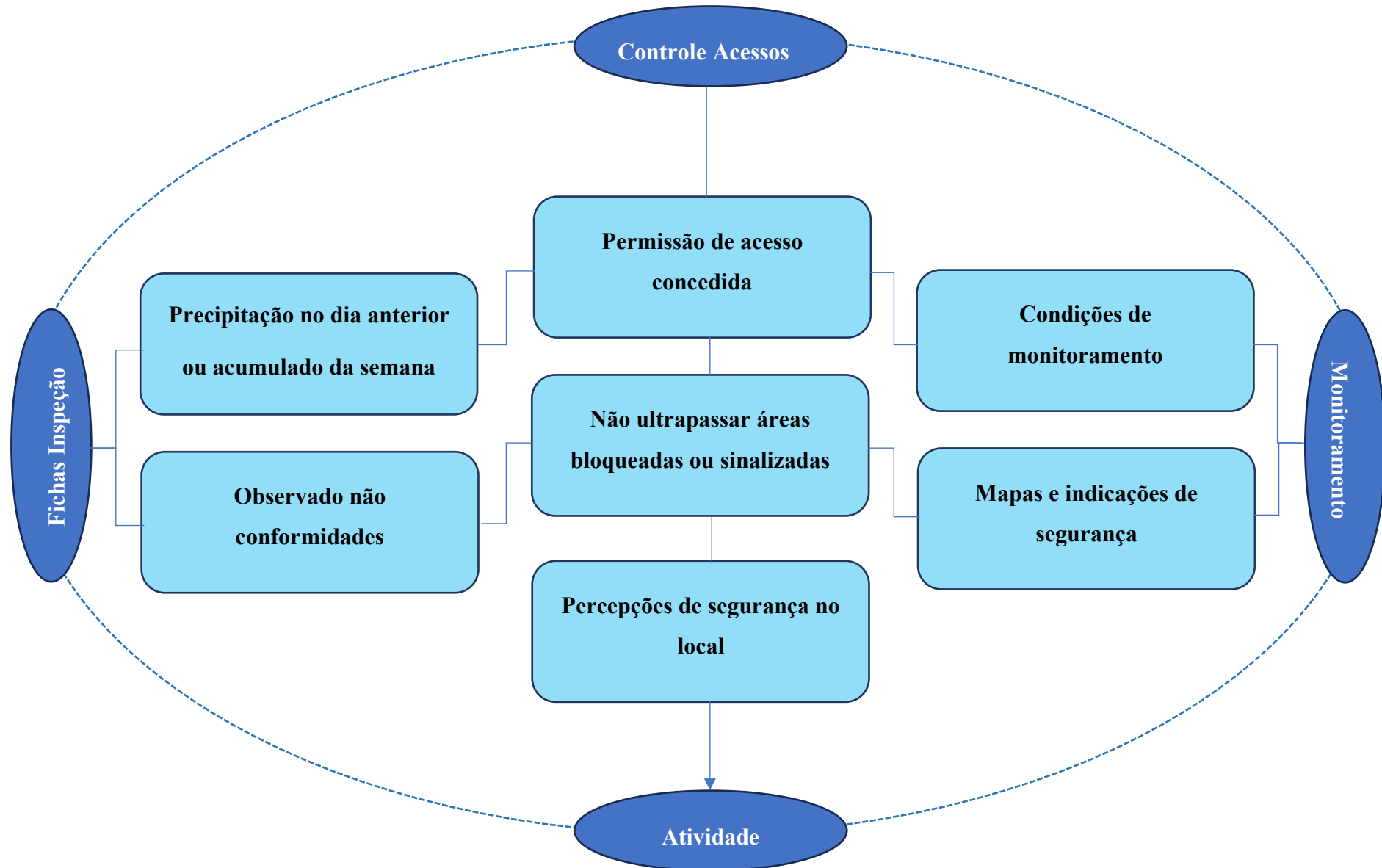
Figura 13 - Fluxograma do Modelo do Protocolo de Segurança para uma cava.
