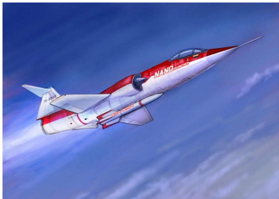
Figura 7: Ilustração do lançador em configuração suborbital (Aeronave F-104 + foguete SpaceSpike-1) Fonte: Matsuda et al. (2010)
