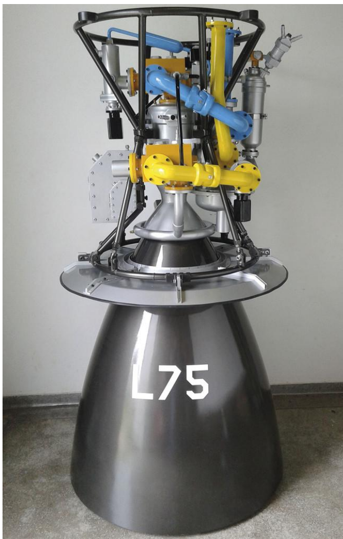
Figura 5: Maquete do motor-foguete L75 Fonte: Vasconcelos (2017)
