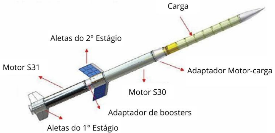
Figura 2: Foguete VSB-30 Fonte: Adaptado de Sousa et al. (2013)
