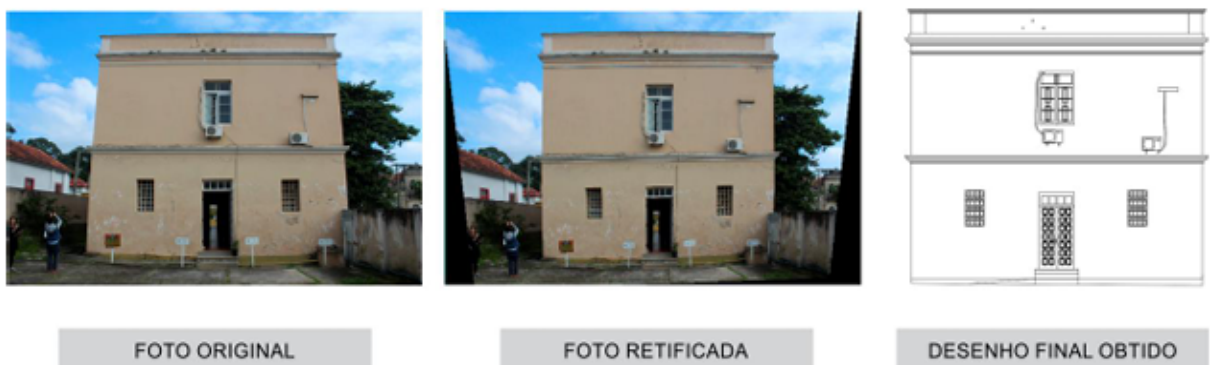
Figura 3 - Processo de monorestituição e desenho técnico de uma fachada.
