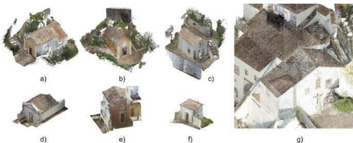
Figura 5 - Imagens isométricas do Revit mostrando os dados da nuvem de pontos de cada capela com dados combinados de varredura laser terrestre e fotogrametria: a) Capela da Penha de França, b) Capela de Nossa Senhora da Piedade, c) Capela do Senhor dos Passos, d) Capela do Dolce Homo, e) Capela da Pietá, f) Capela do Senhor Amarrado e g) Igreja Matriz.
