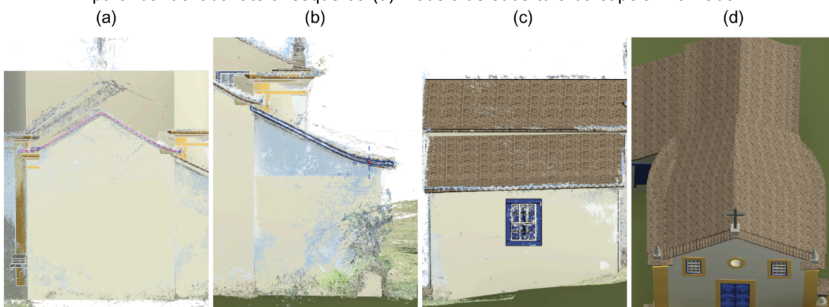
Figura 40 - Processo de modelagem dos telhados. (a) Ferramenta de desenho de telhado por extrusão; (b) Perfil de telhado, usada na ferramenta Sweep (varredura); (c) Telhado inclinado visto a partir da fachada lateral esquerda (d) Modelo de cobertura da capela finalizado.
