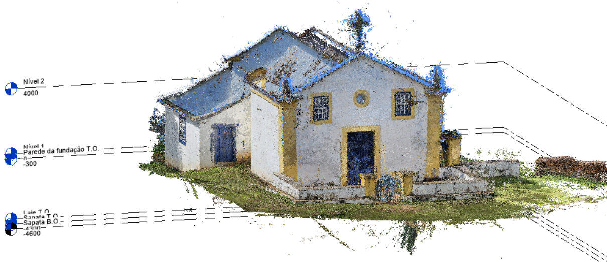
Figura 29 - Nuvem de pontos gerada na qualidade alta, inserida no programa Autodesk Revit 2025.
