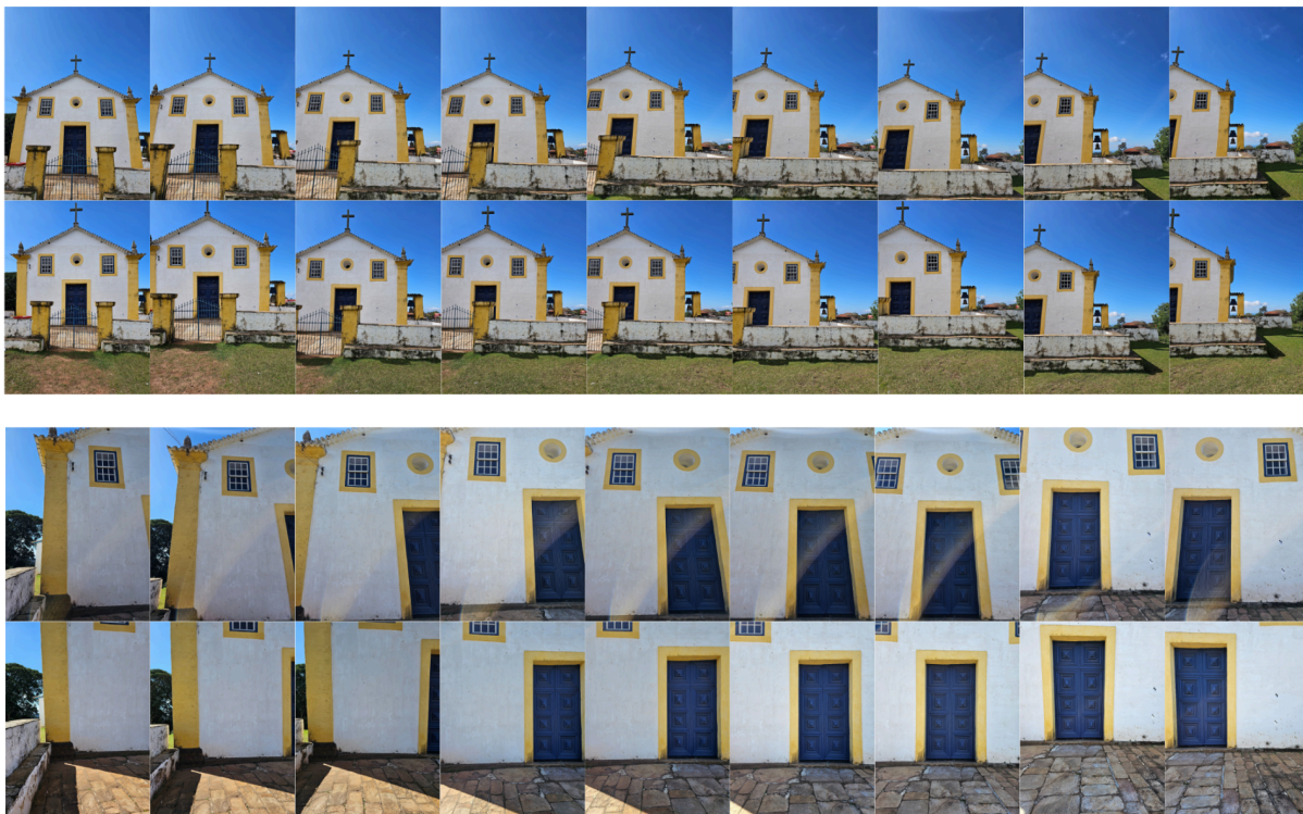
Figura 20 - Conjuntos de fotos demonstrando o método da tomada de fotos em sobreposição manual.
