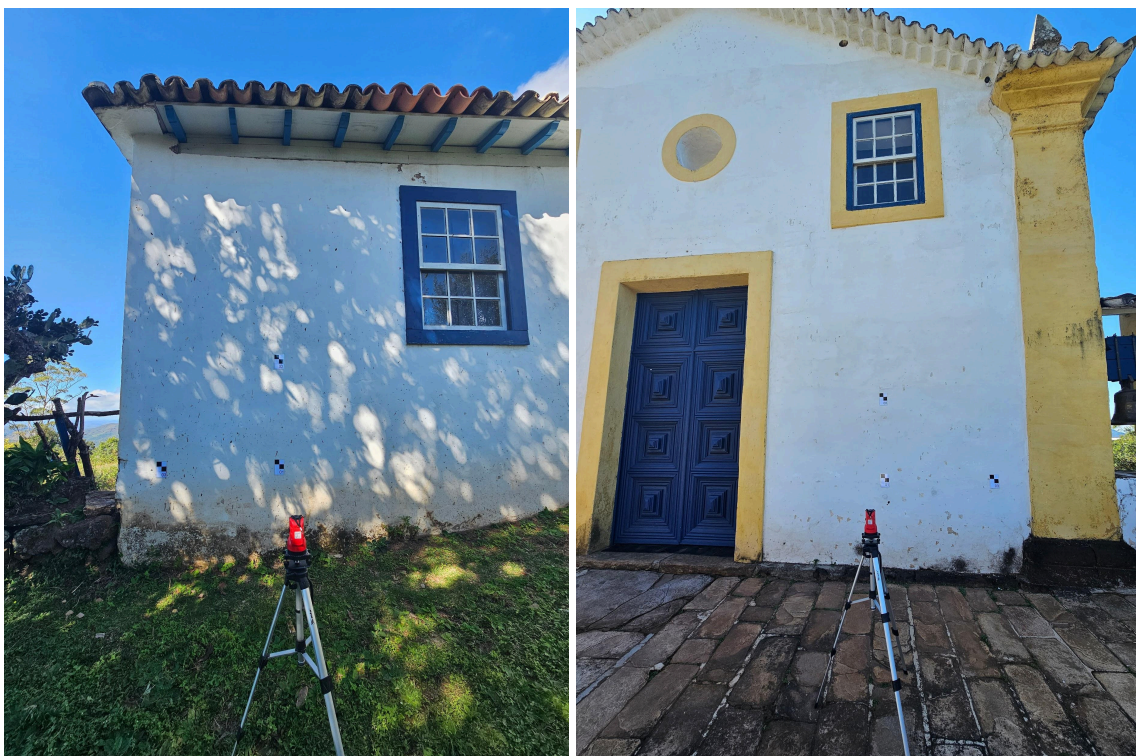
Figura 21 - Marcadores posicionados com nível a laser nas fachadas frontal e lateral esquerda, para a obtenção das medidas de referência.
