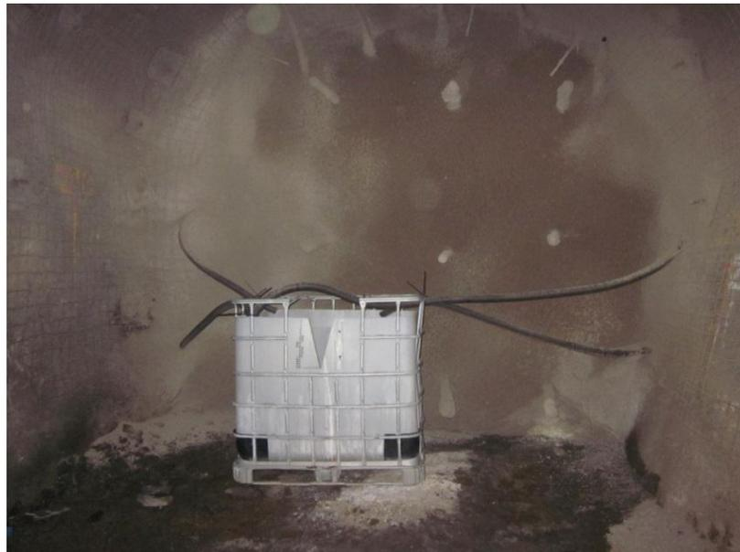
**Figura 15** - Barricada com drenagem em teste na Mina Raleigh (Hasan *et al.*, 2013).
