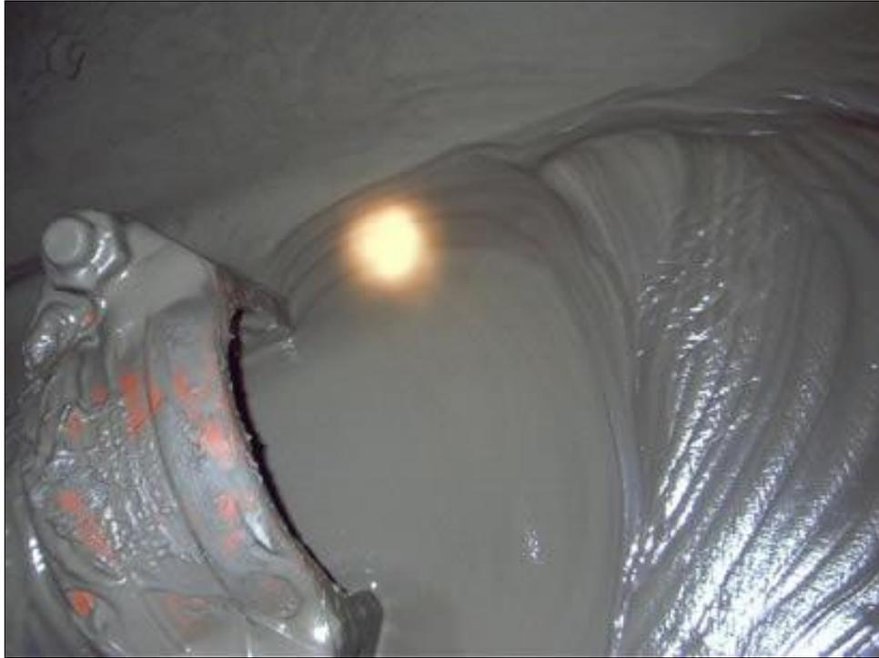
**Figura 3** - Consistência de um *backfill*, Boulby Mine, Reino Unido (Paterson e Cooke, 2003).
