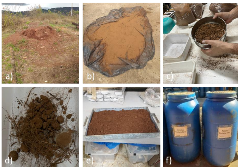
Figura 2 - a) Armazenamento do rejeito ao ar livre; b) Secagem do material sobre lonas; c) Peneiramento; d) Material retido; e) Material passante; f) Bombonas de armazenamento
