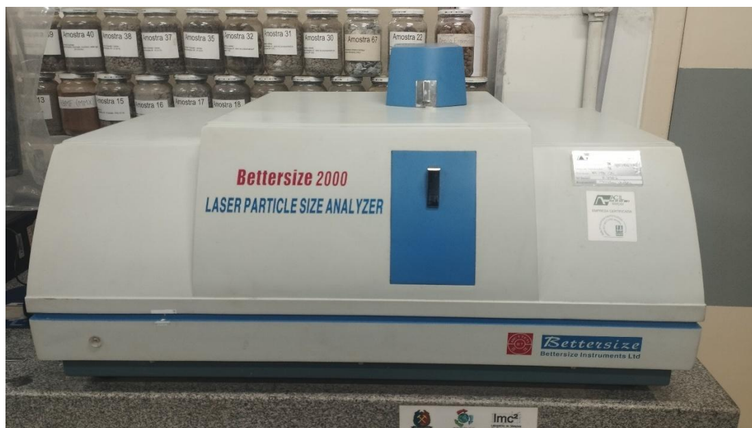
Figura 3 – BETTERSIZE 2000 utilizado para análise granulométrica
