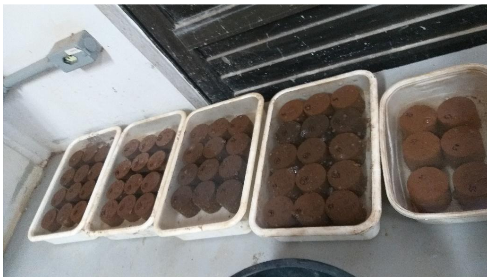
Figura 10 – Ensaio de absorção de água
