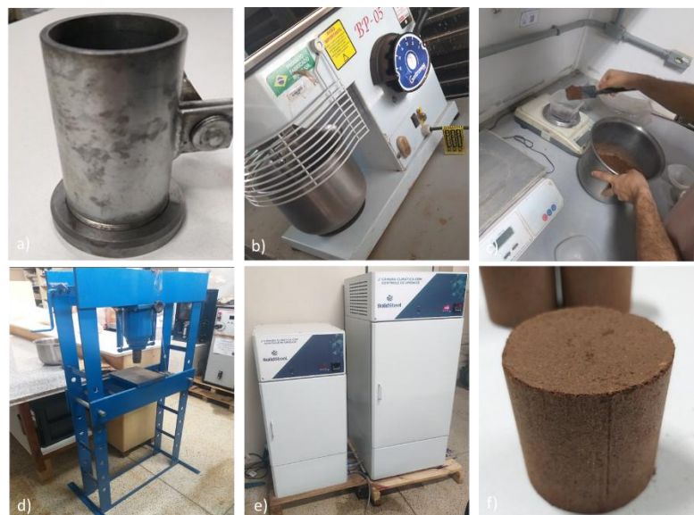
Figura 7 – a) Molde cilíndrico; b) Argamassadeira; c) Balança para pesagem; d) Prensa manual de compressão; e) Câmara climática; f) Corpo de prova extraído
