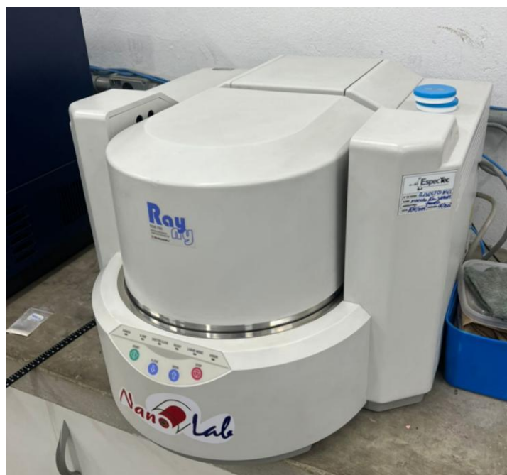
Figura 4 – Shimadzu EDX-720 utilizado para análise de composição química
