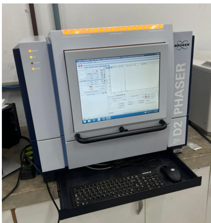
Figura 5 – Bruker D2 Phaser 2ª Generation utilizado para análise mineralógica
