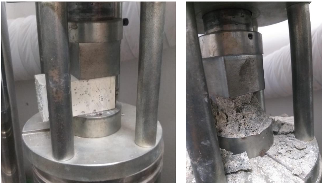
Figura 14 - Ensaio a compressão.
