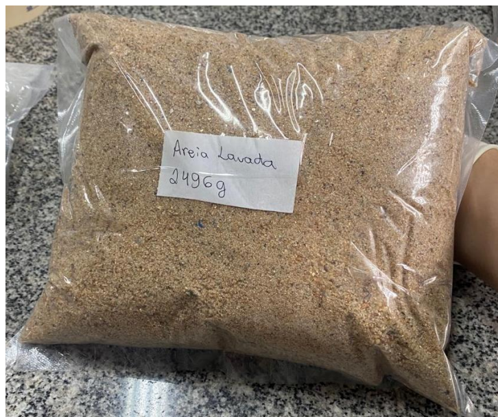
Figura 9 - Areia utilizada no preparo da argamassa.
