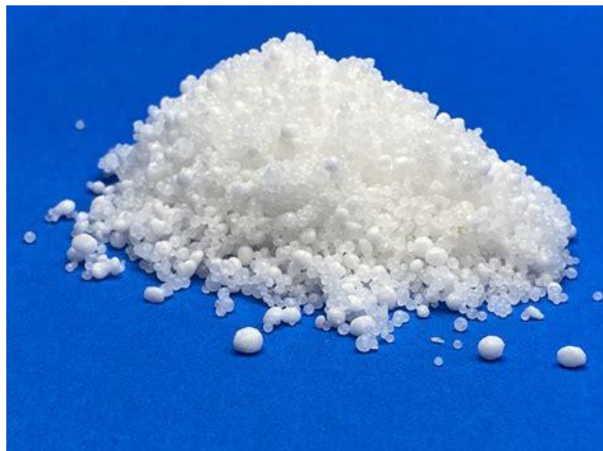
Figura 1. Prills porosos de nitrato de amônio (porção granulada típica usada na preparação de ANFO). Fonte: adaptado de LÉONARD et al. , 2020.
