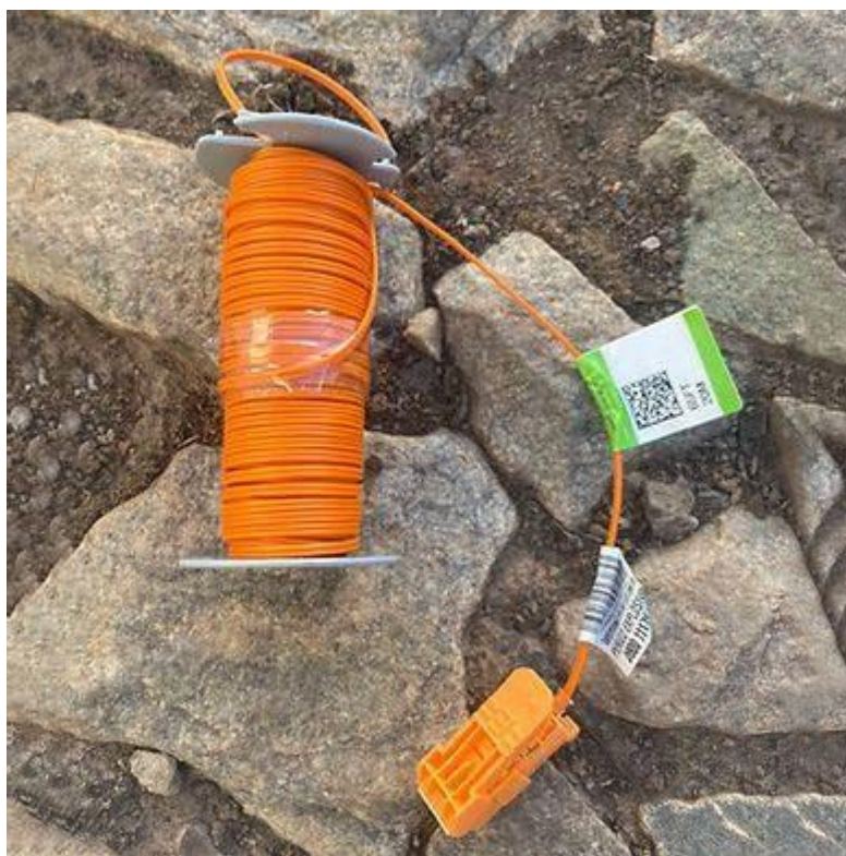
Figura 4. Espoleta Eletrônica utilizada em operações de detonação em mina subterrânea.
