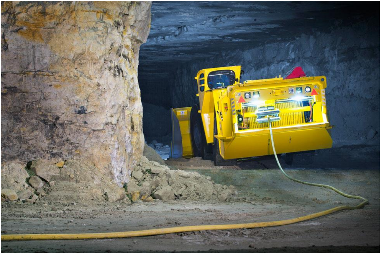
Figura 3- LHD elétrica Scooptram EST1030 com capacidade de 10 toneladas equipada com cabo de arraste (MINING AND CONSTRUCTION, 2013).
