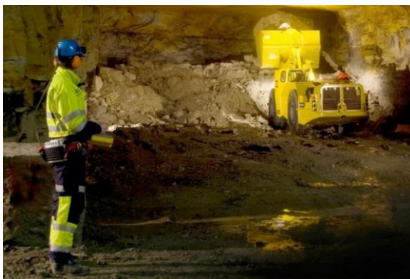
Figura 2: Carregadeira LHD operada por controle remoto (MINING AND CONSTRUCTION, 2013).
