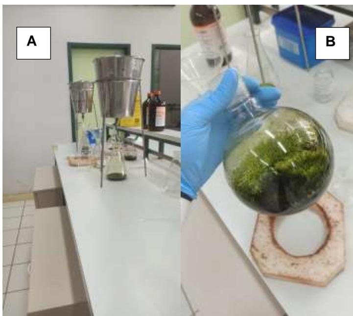
**Figura 10 – A) Processo de percolação do material vegetal e B) Extrato etanólico após a retirada do solvente extrator por rotaevaporação.**
