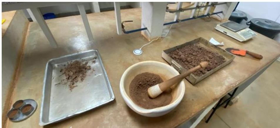
O teor de umidade natural das amostras foi determinado por meio da pesagem de cápsulas metálicas, também visualizadas na Figura 7, antes e depois do aquecimento em estufa, conforme procedimento padrão. As cápsulas foram levadas à estufa a  $105 \pm 5$  °C até massa constante, permitindo o cálculo da umidade gravimétrica.
