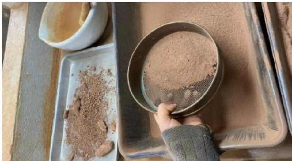
Em seguida, foi realizado o ensaio de sedimentação do material fino em proveta, efetuando-se as leituras no densímetro nos intervalos de tempo estabelecidos pela norma, conforme ilustrado na Figura 11. Concluída essa etapa, o material decantado foi transferido para bandejas e levado à estufa para secagem, a fim de possibilitar o peneiramento fino subsequente.
