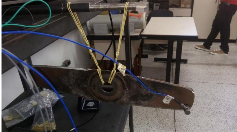
Figura 13 – Posição do acelerômetro na lâmina
