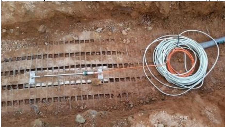
Figura 15 – Exemplo da aplicação de extensômetro tipo corda vibrante em geogrelha.
