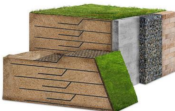
Figura 7 – Ilustração esquemática demonstrando o funcionamento do solo reforçado de maneira genérica – com paramento e sem paramento.
