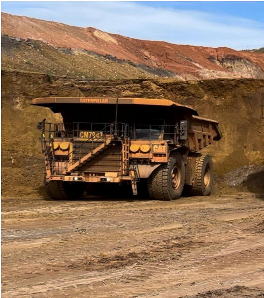
Segundo Quevedo (2009), o ciclo operacional do transporte com caminhões (Figura 7) inicia-se com o carregamento da caçamba por um equipamento de carga. Após esse processo, os caminhões seguem até o local de descarga que pode ser uma pilha de estéril, de homogeneização ou o britador onde depositam o material transportado. Em seguida, retornam ao ponto de lavra para novo carregamento, repetindo esse fluxo de maneira contínua.
