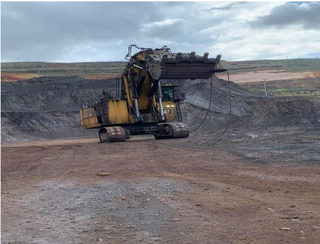
Segundo Ricardo e Catalani (2007), ao contrário das pás carregadeiras, o ciclo de carregamento das escavadeiras não inclui o deslocamento do equipamento. Isso ocorre porque as escavadeiras operam de forma estacionária, realizando a escavação e o carregamento sem a necessidade de movimentação, devido à sua baixa velocidade de deslocamento e às características operacionais previamente
