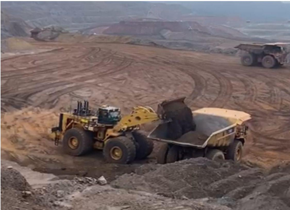
As carregadeiras são amplamente empregadas em operações de mina a céu aberto, principalmente como equipamentos auxiliares. São frequentemente utilizadas para substituir escavadeiras em manutenção e para realizar ajustes na qualidade do ROM, especialmente em pilhas de estocagem durante períodos chuvosos, assegurando a continuidade da alimentação do britador (TEIXEIRA, 2016).
