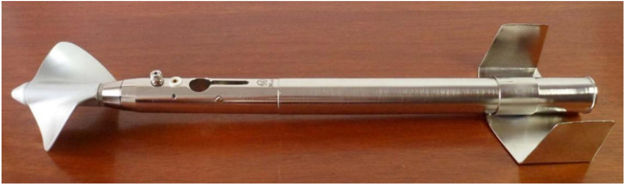
Figura 3 - Molinete Fluviométrico Universal Marca Medir. Fonte: APARELHOS MEDIR (2023).
