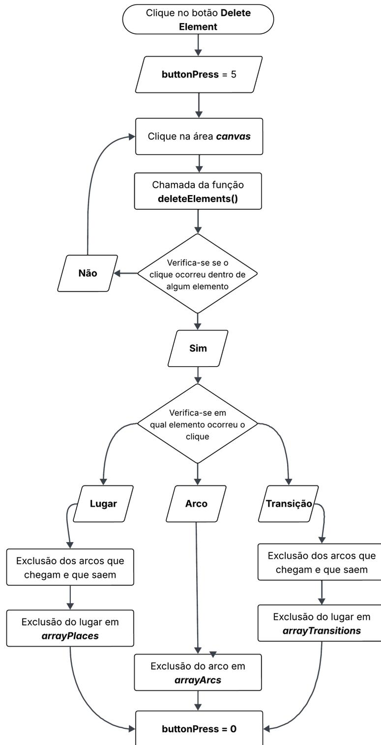
Figura 34 – Diagrama de fluxo para deletar um elemento
