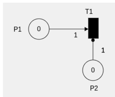
Figura 30 – Arco normal e inibidor chegando transição T1
