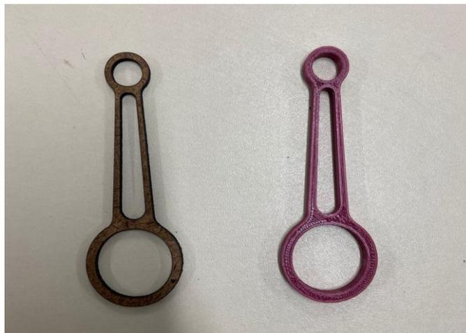
*Figura 15 – Peça "Shuriken" impressa em 3D com filamento PLA, representando a diversidade geométrica explorada na disciplina ENP 701 – Engenharia de Processos Mecânicos.*
