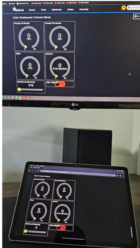
Figura 12 – Dash (painel de controle) aberta em um computador e em um dispositivo móvel. Fonte: O Autor
