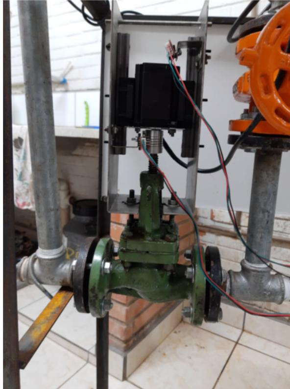
Figura 1 – Válvula adaptada com o motor montada na bancada. Fonte: (CARDOSO, 2021)
