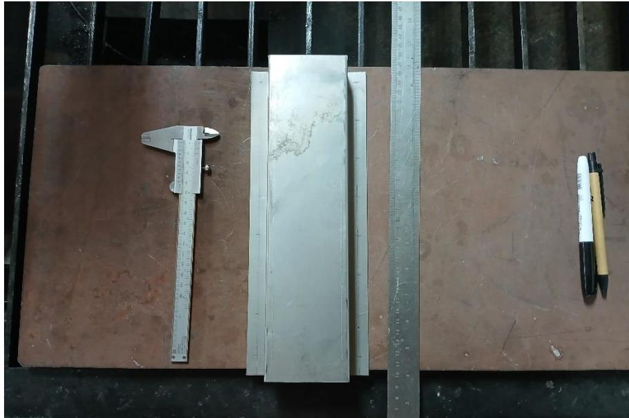
Figura 10 - Processo de marcação para soldagem a ponto por resistência nas longarinas
