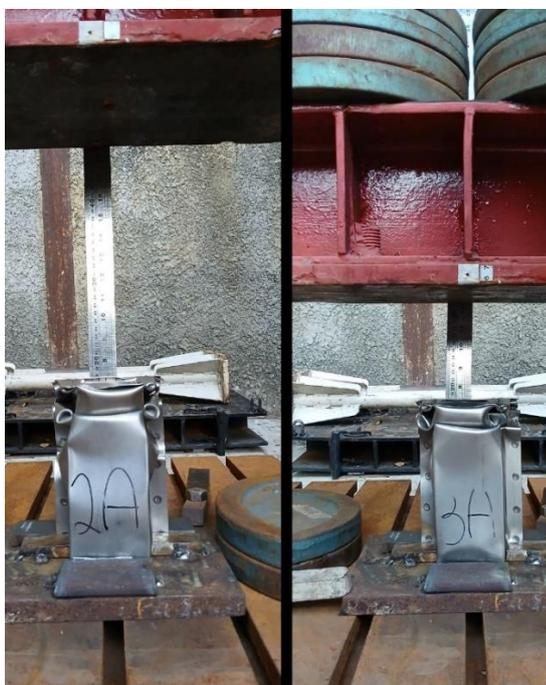
Figura 15 – Comparativo de deformação nas longarinas tipo A
