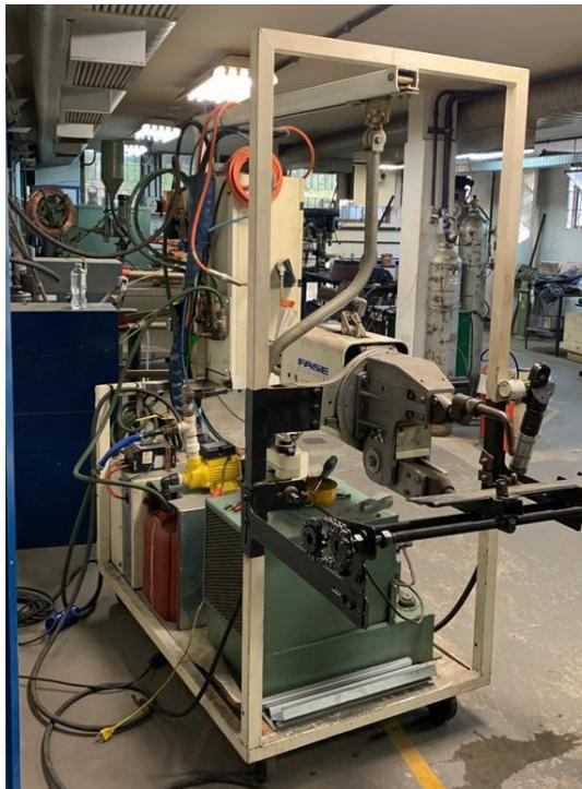
Figura 6 - Máquina de soldagem a ponto por resistência elétrica
