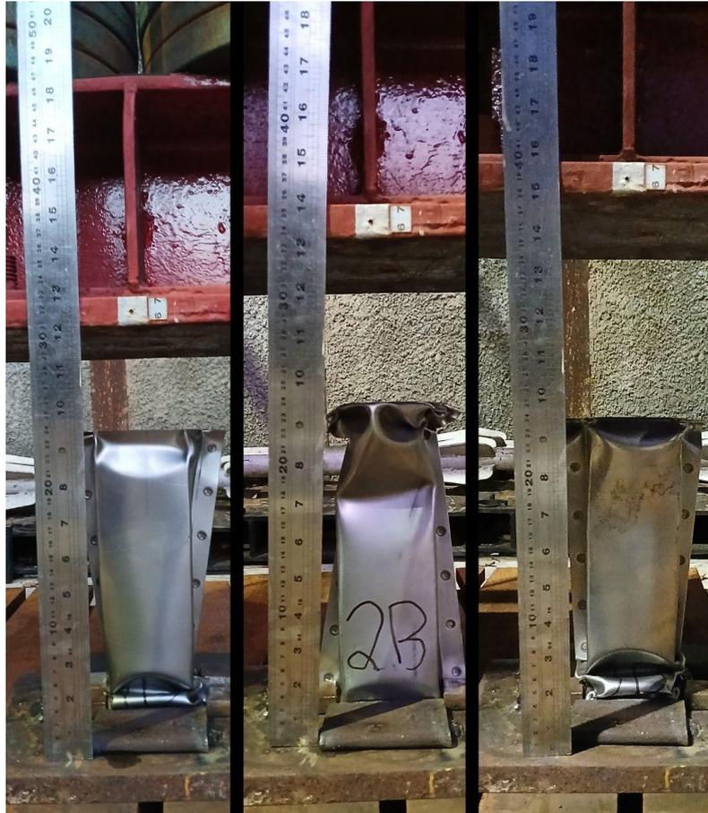
Figura 16 – Comparativo de deformação nas longarinas tipo B
