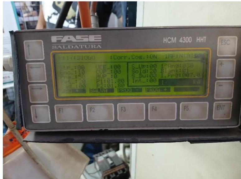
Figura 7 – Parâmetros utilizados na unidade de programação móvel da máquina de solda por resistência elétrica
