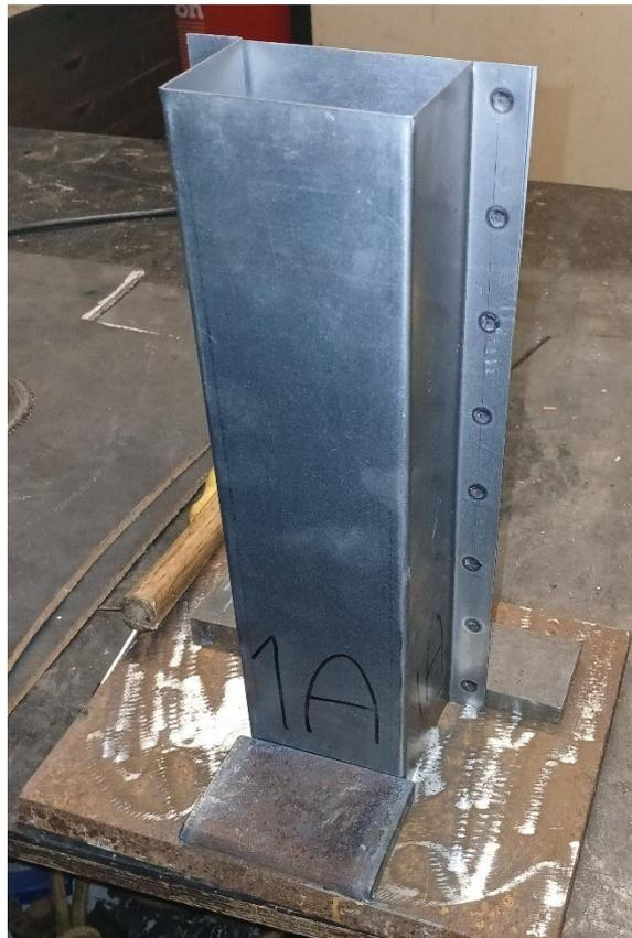
Figura 18 – Processo de construção das bases de fixação
