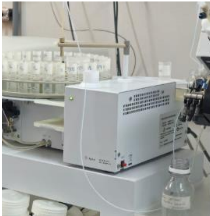
Figura 12: Amostras do presente estudo, já solubilizadas, em momento de análise no ICP-MS.
