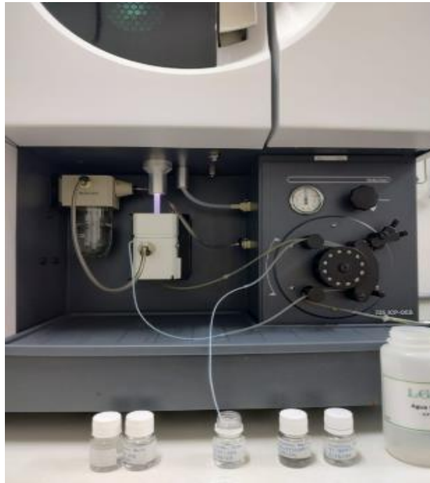
Figura 11: Amostras do presente estudo, já solubilizadas, em momento de análise no ICP-OES.
