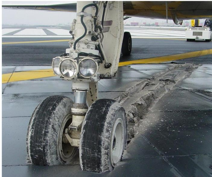
Figura 1: Aeronave freada após entrar em contato com a superfície do EMAS (Evans, 2010).
