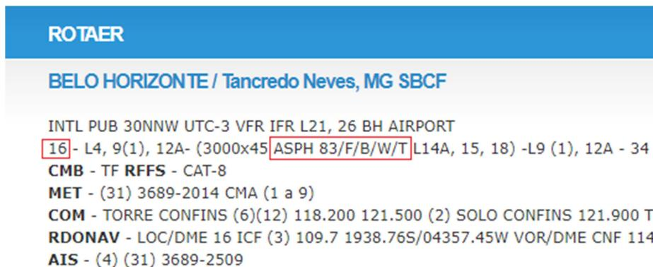
Figura 3: Rotaer referente ao aeroporto Tancredo Neves da cidade de Belo Horizonte, MG. Informações relacionadas às dimensões da pista e ao PCN se encontram dentro do retângulo vermelho (Departamento de Controle do Espaço Aéreo, 2017).
