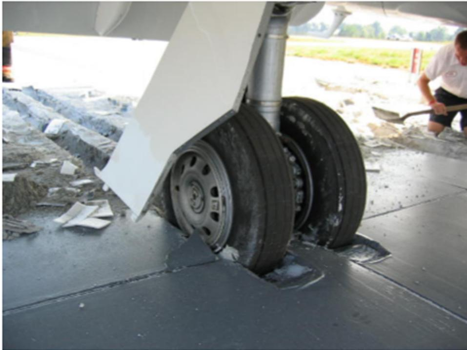
Figura 10: Aeronave freada pelo EMAS após excursão em pista (Ho & Romero, 2009).
