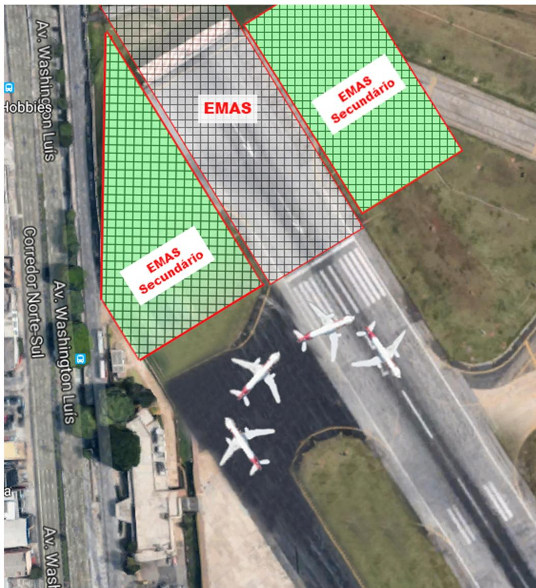
Figura 21: Simulação da implantação dos EMAS secundários e pista de táxi prolongada até a cabeceira da pista.
