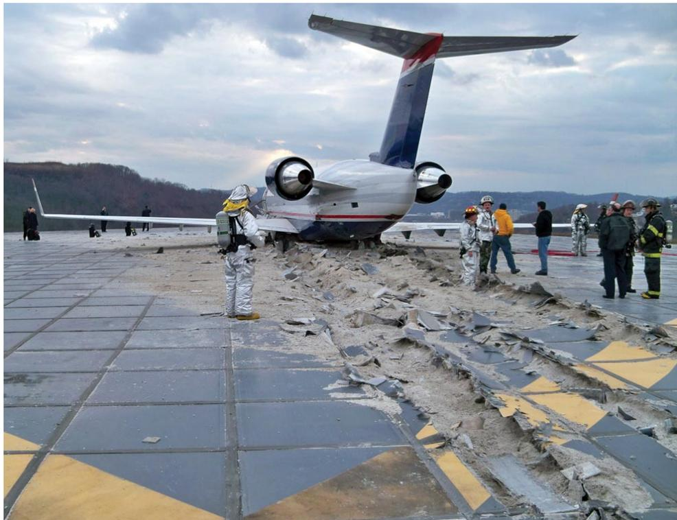
Figura 9: : Aeronave freada pelo EMAS após excursão em pista (Ho & Romero, 2009).
