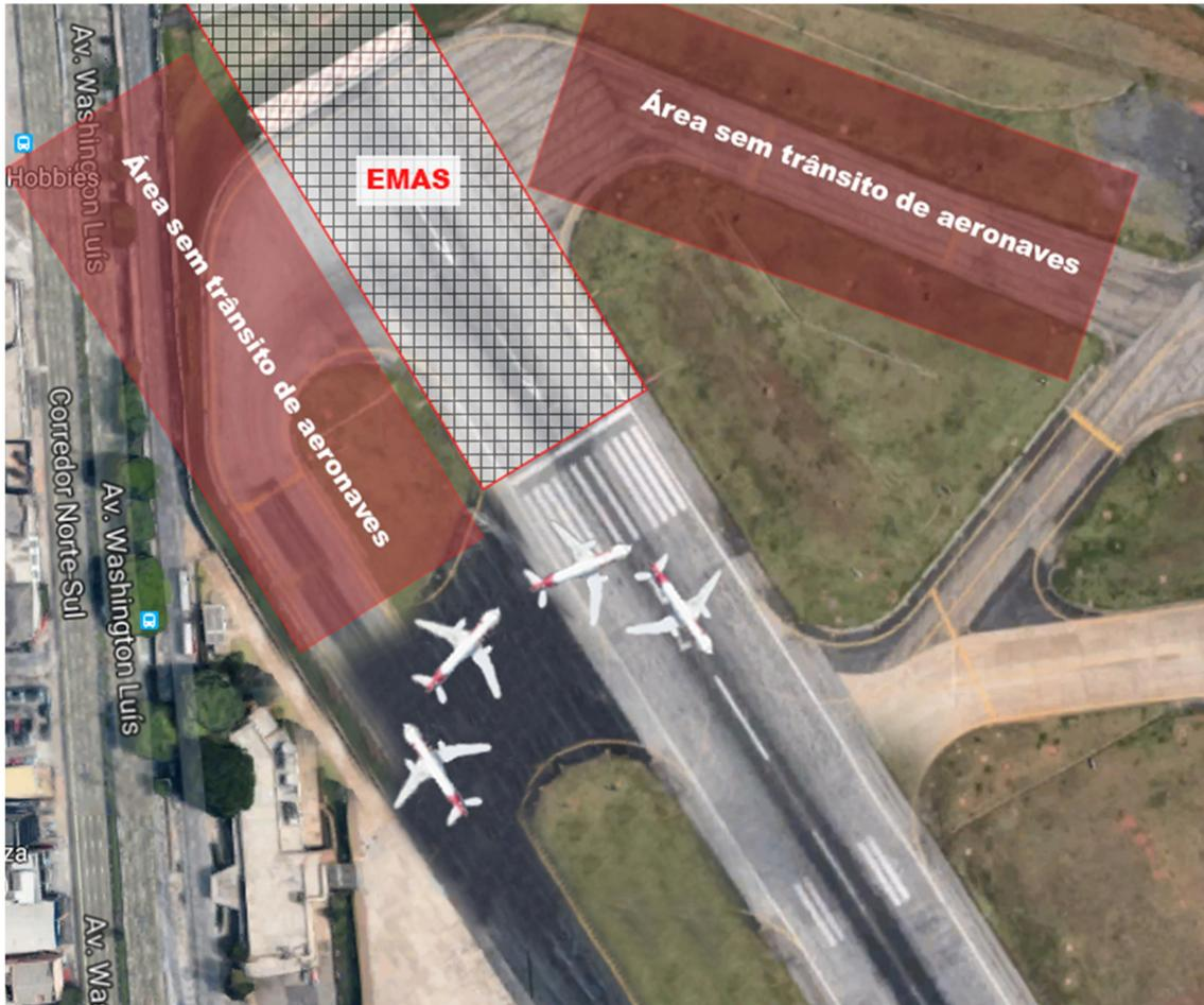
Figura 19: Simulação da pista de decolagem após emprego do EMAS e pistas de táxi inativas em vermelho.
