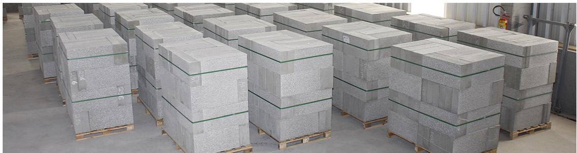
Figura 22: Blocos pré fabricados de concreto celular disponíveis no mercado brasileiro (AVS, 2017).
