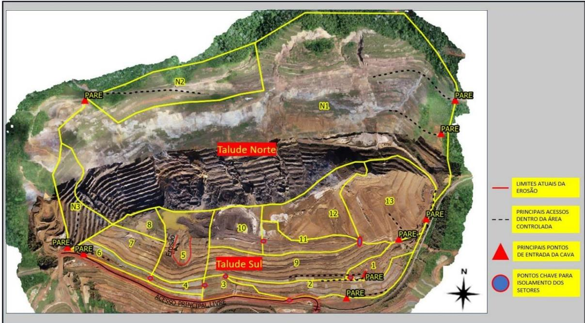
Figura 9 - Setorização geotécnica da cava e pilha.
