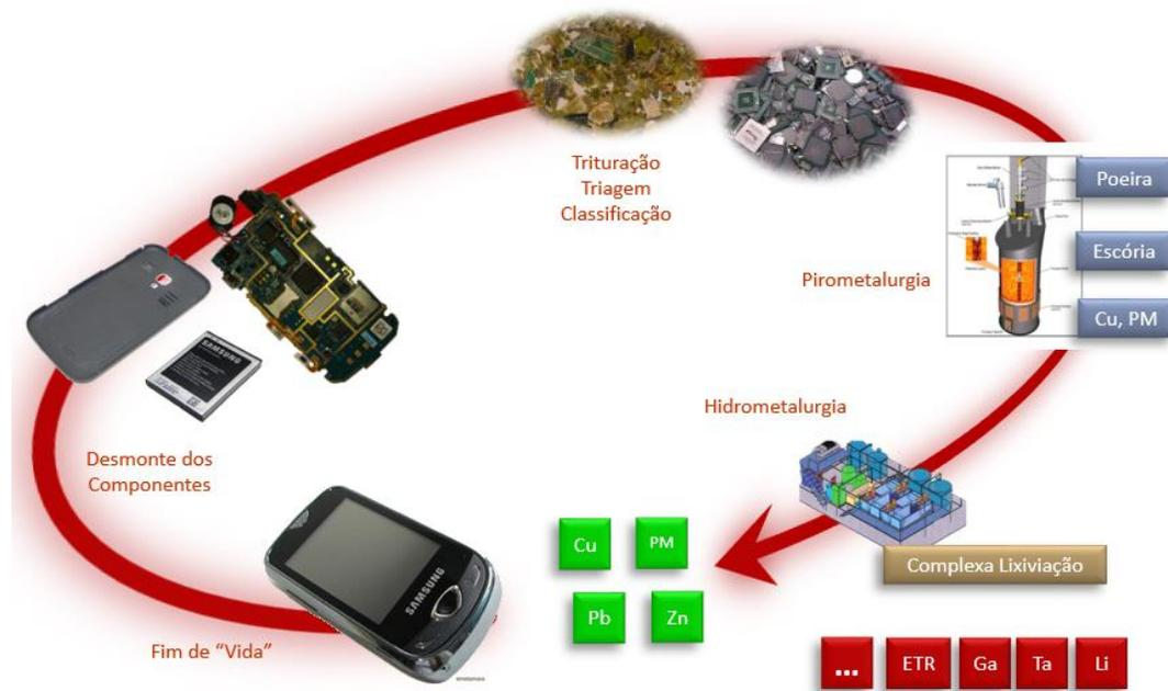
**Figura 6.1:** “Ciclo de Vida” de um Aparelho Celular, com reciclagem de metais de valor. “Ecogeometalurgia”.
