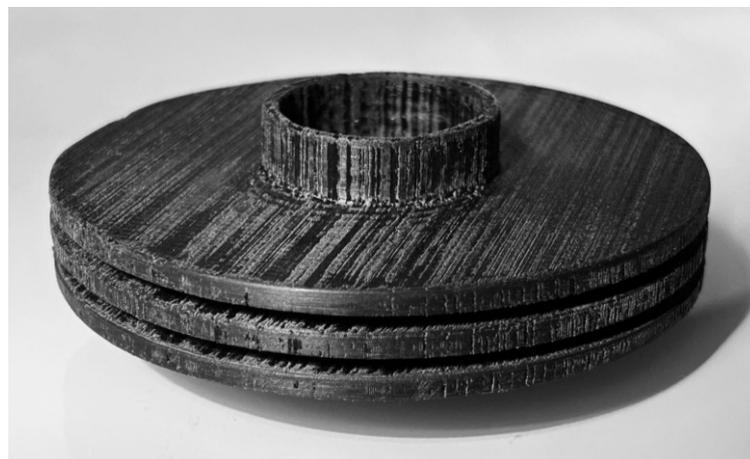
Figura 30 – Protótipo físico do rotor de discos em material termoplástico.
