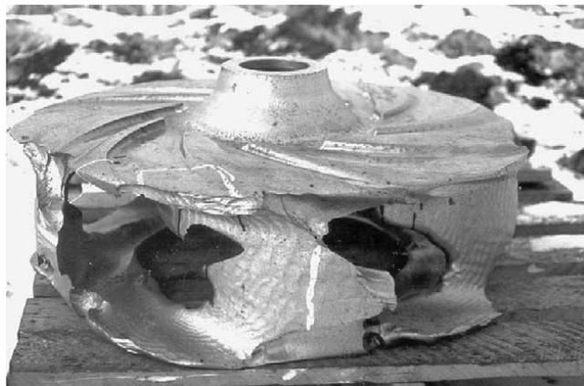
Figura 5 – Desgaste em impelidor após 3 meses.
