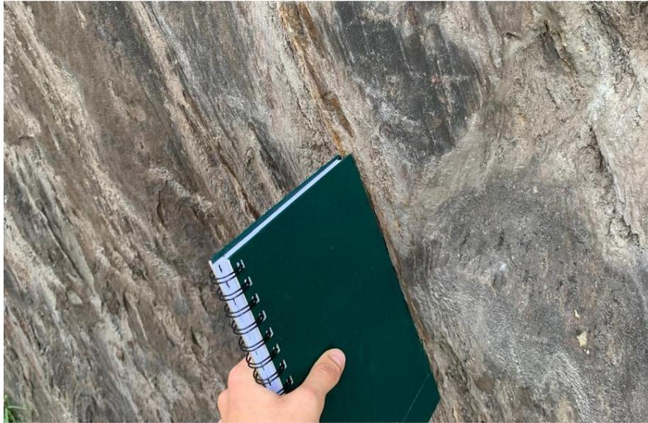
Figura 10 - Plano de foliação estendido com o auxílio da caderneta de campo para facilitar a medição da angulação.
