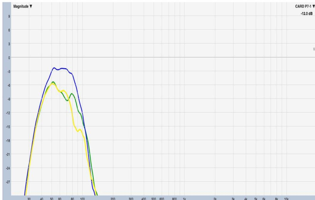
De acordo com a simulação, os três pontos deveriam ter mesma amplitude. Porém, nota-se pela Figura 67 que os pontos 5 e 7 tem cerca de 3 dB a menos que o ponto 6. Apesar dos pontos 5 e 7 terem menores amplitudes, sua resposta no domínio da frequência são praticamente iguais. Isso quer dizer que os dois lados do sistema estão respondendo de maneira semelhante.
