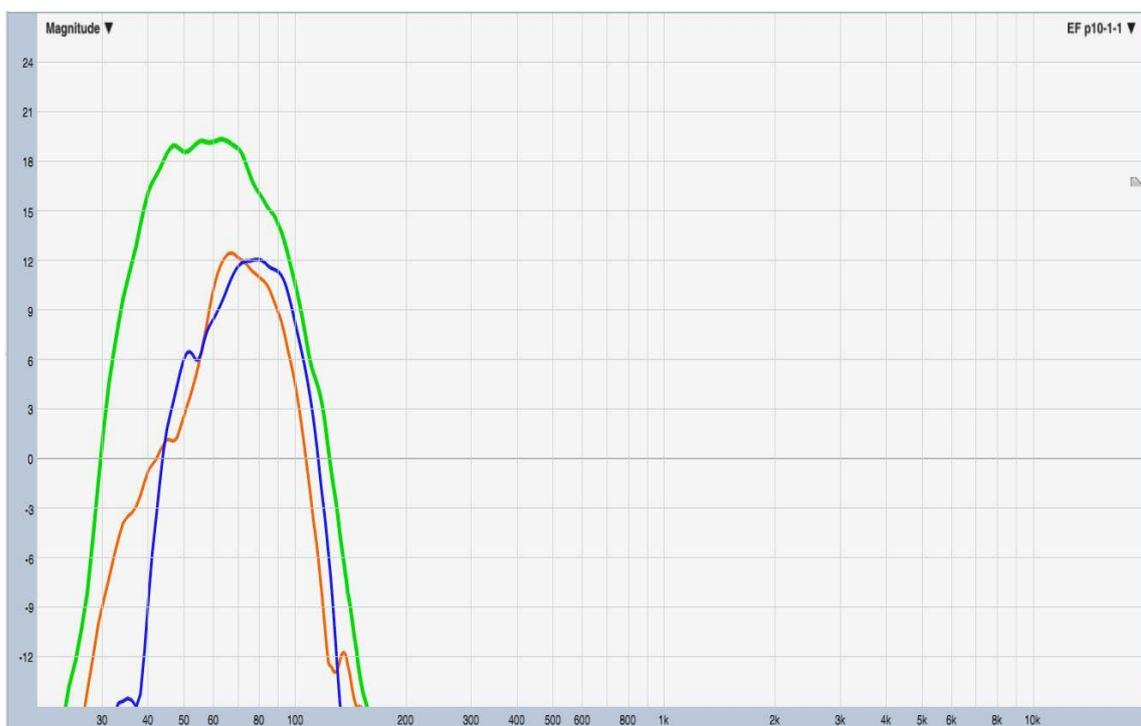
Figura 64: Resposta SPL grupo E arranjo end-fire. Ponto 10: verde. Ponto 12: vermelha. Ponto 13: roxa.
