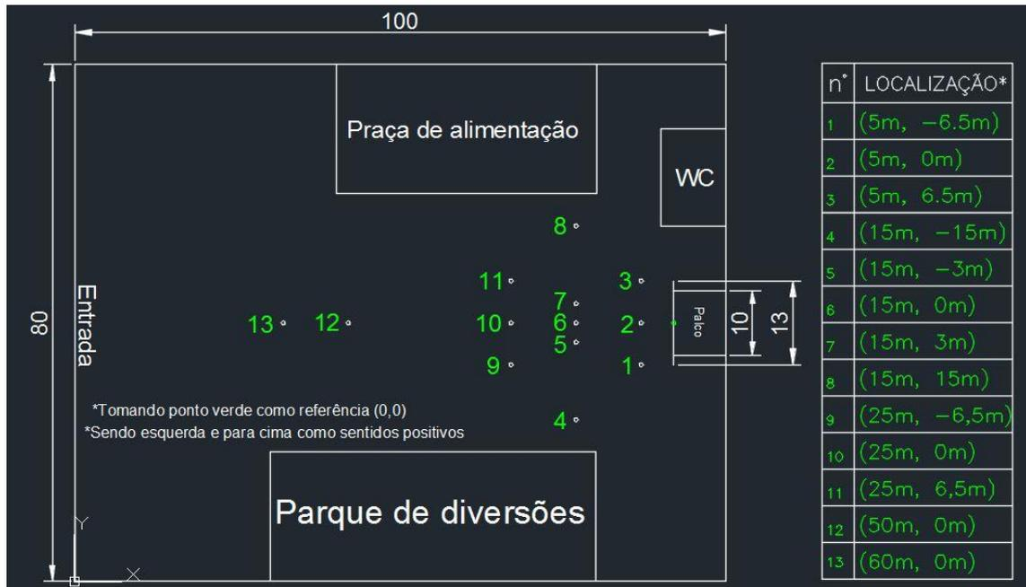
Após criar a área de trabalho no ambiente NS-1, foram adicionados os equipamentos a serem utilizados. Nas simulações são utilizadas 18 unidades da GEO S1210 e seis unidades da GEO S1230 para reprodução das altas frequências. As caixas de subgrave são do modelo SUB RS18 são utilizadas em 24 unidades.
