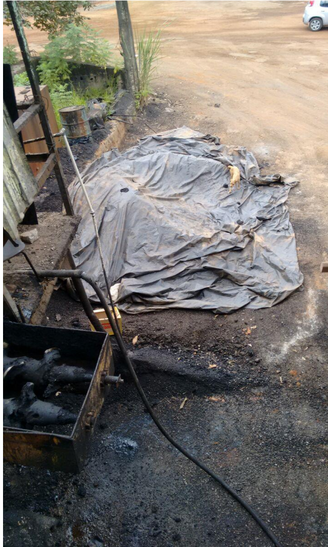
Figura 8: Mistura asfáltica armazenada.
