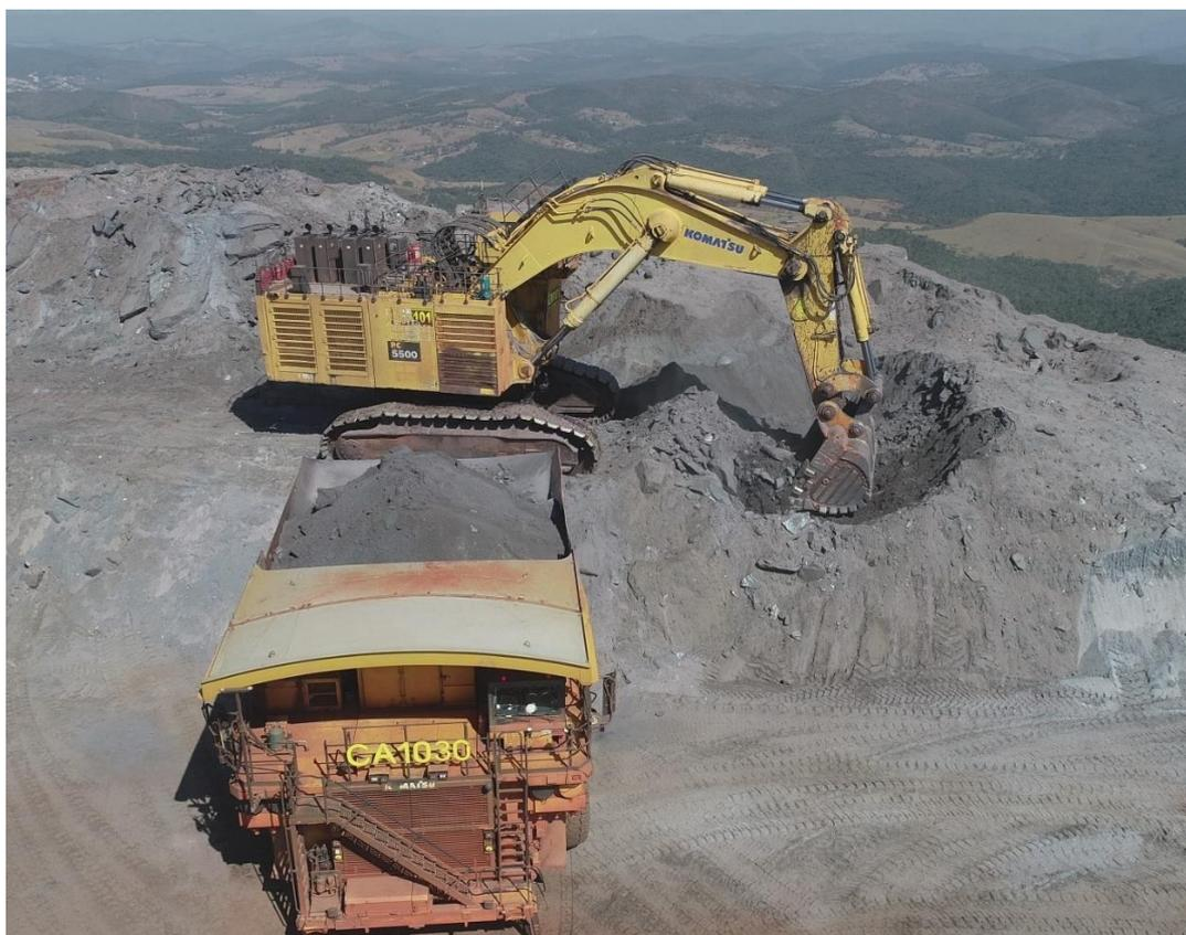
Figura 6 – Carregamento *Backhoe* – Modelo PC5500 da Fabricante Komatsu
