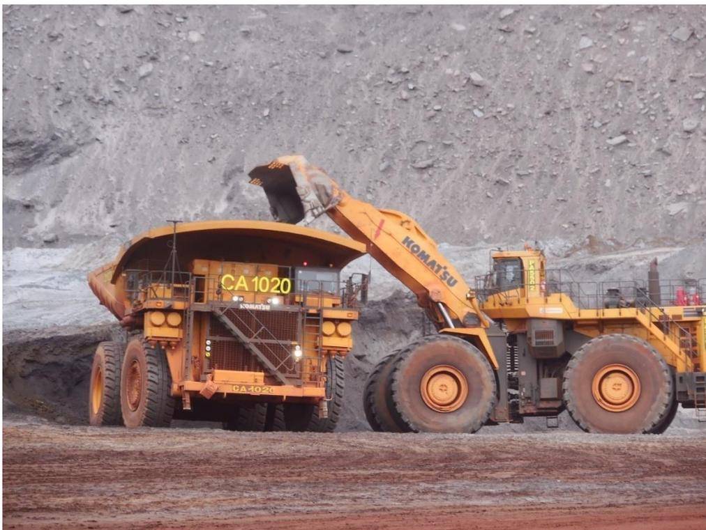
Figura 3 – Carregamento Carregadeira WA1200 da Fabricante Komatsu
