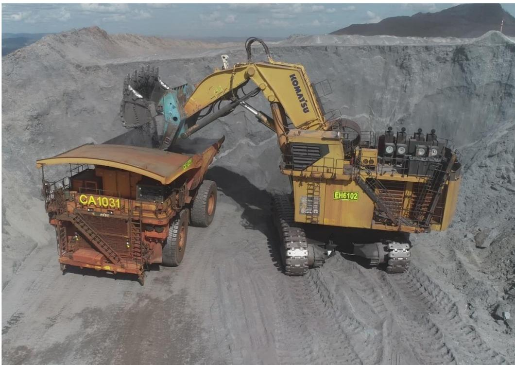
Figura 5 – Carregamento *Front Shovel* - Modelo PC5500 da Fabricante Komatsu
