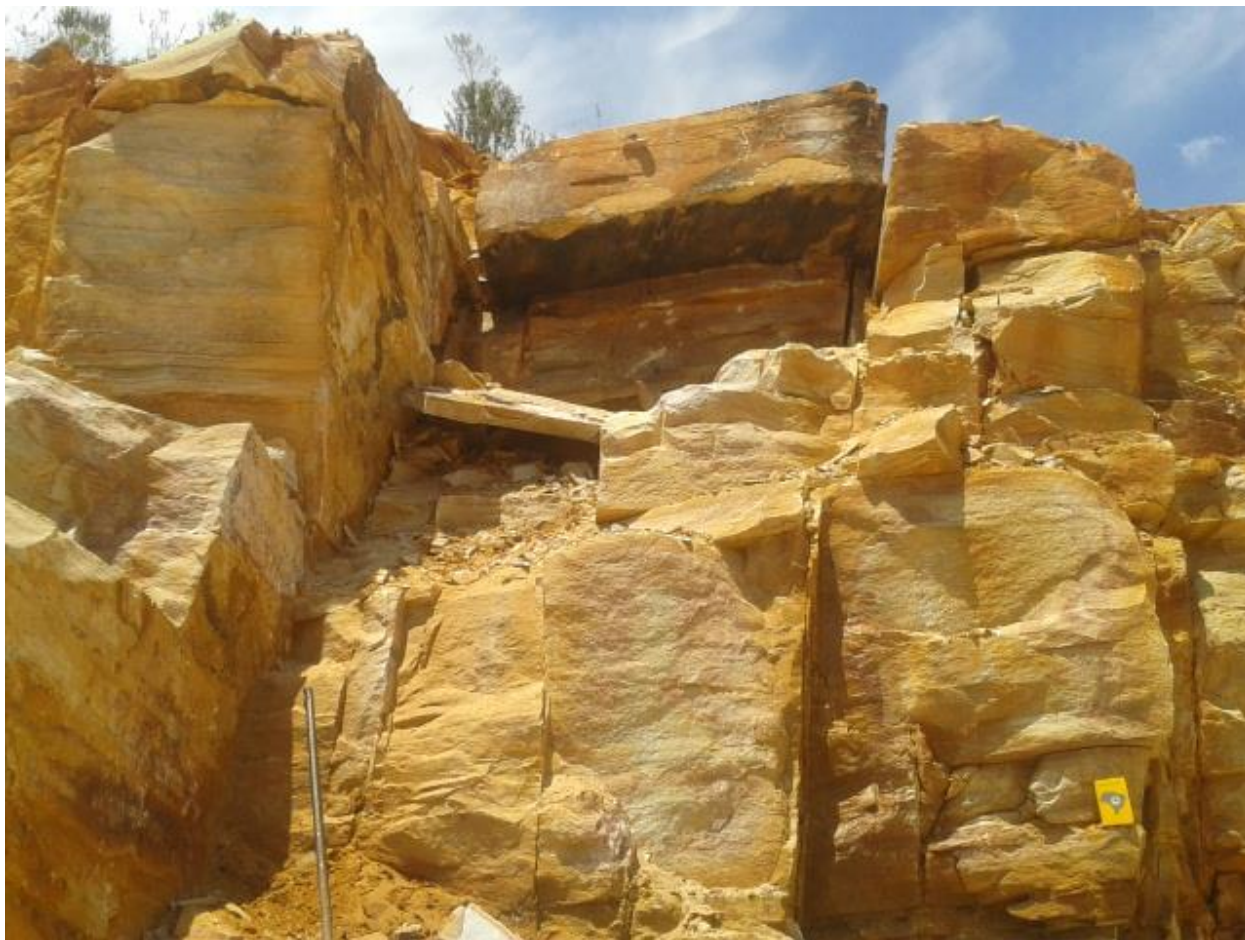
Figura 15 - Família de fraturas principal.
