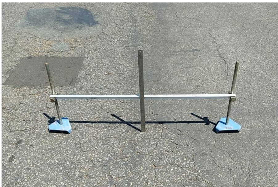
Figura 32 - Aparelhagem utilizada na medida das flechas das trilhas de roda. Fonte: Acervo próprio.
