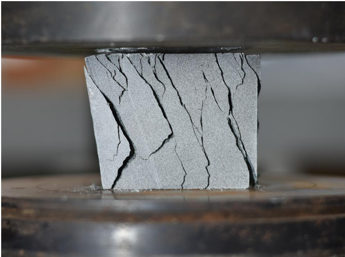
Figura 11 - Registro do corpo de prova após a ruptura
