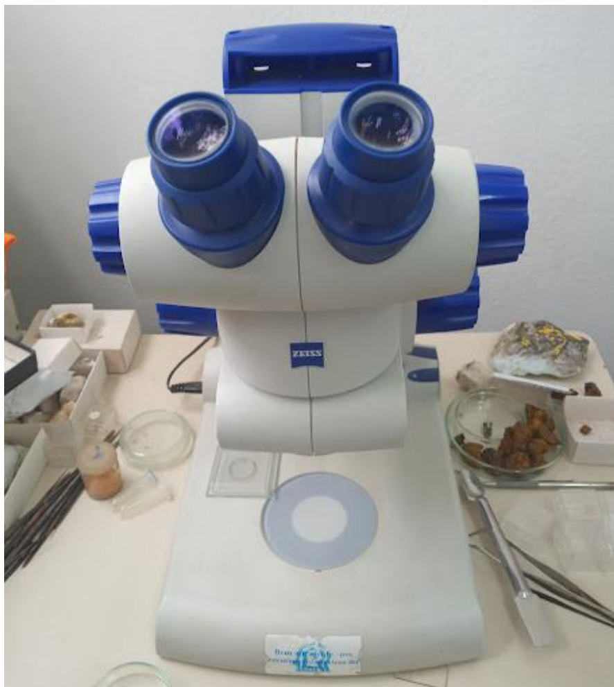
Figura 9: Lupa binocular utilizada para seleção dos minerais.
