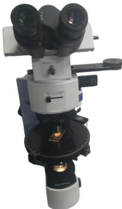
Figura 10: Microscópio petrográfico Olympus BX-41 utilizado para descrição das lâminas delgadas polidas.
