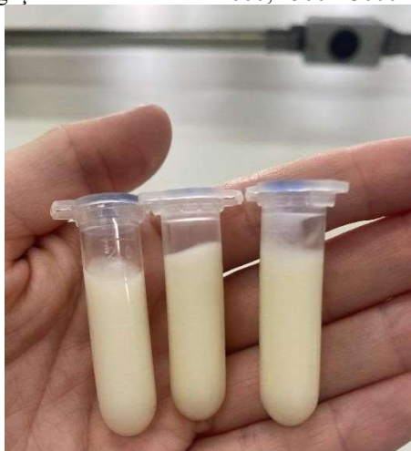
Figura 5. Aliquotas contendo 2mL das amostras OEC-1, OEC-2 e OEC-3, respectivamente, apresentando estabilidade após testes de centrifugação nas velocidades 1000, 2500 e 3000 rpm, à temperatura ambiente.
