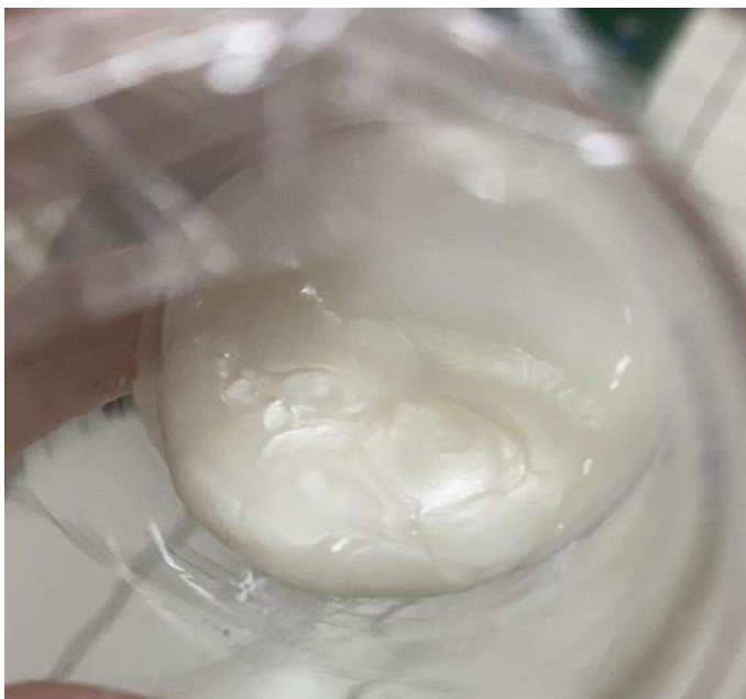
Figura 12. Amostra OAC-2. Avaliação macroscópica apresentando cremeação após 24h em estufa à 45°C.
