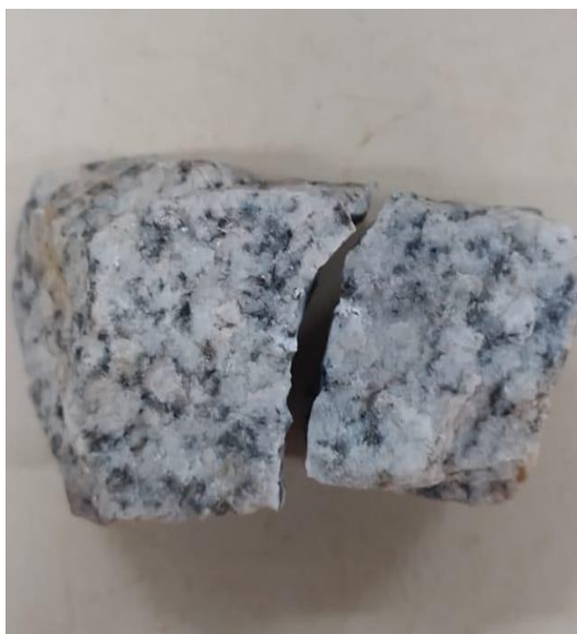
Figura 25 – Modo de ruptura do gnaiss.
