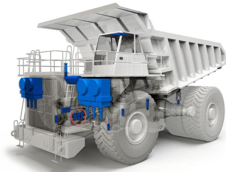
Figura 7: Diferentes sistemas de filtragem em um caminhão fora de estrada com o sistema de filtragem de combustível em destaque.
