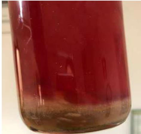
Figura 14: partículas repelidas do combustível após utilização do filtro em testes
