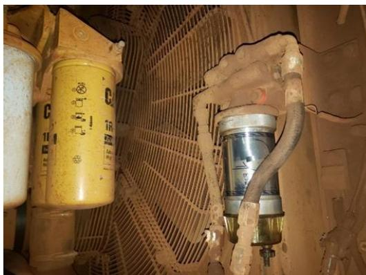
Figura 17: filtro devidamente instalado em um caminhão
