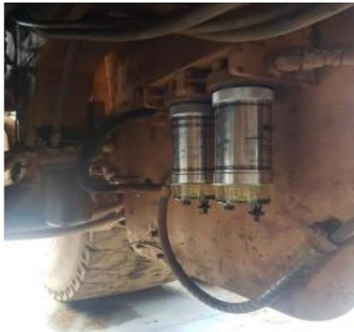
Figura 8: Sistema de filtragem de combustível do caminhão fora de estrada.
