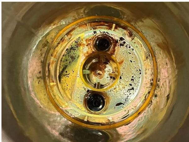
Figura 18: Particulado expurgado do filtro após um dia de funcionamento do caminhão na mina
