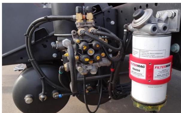
Figura 1: Filtro separador de água do diesel aplicado em um caminhão.
