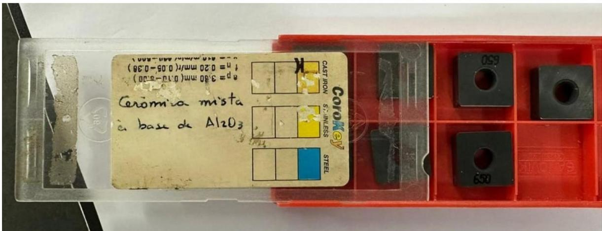
Figura 6 – Insertos de cerâmica mista utilizados nos ensaios
