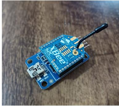
Figura 3 – Módulo XBee. Fonte: De autoria própria
