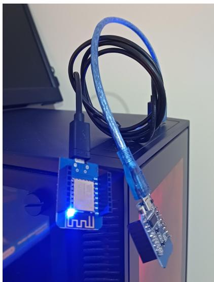
Figura 32 – Foto dos Wemos conectados à porta COM do computador. Fonte: De autoria própria.
