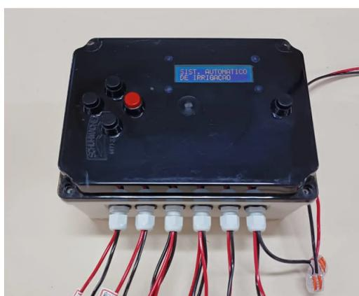
Figura 7 – Controlador de irrigação. Fonte: (AUTOMAÇÃO, 2021).
