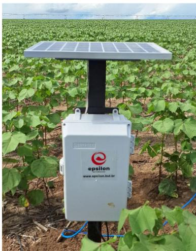
Figura 6 – Estação de monitoramento de umidade do solo em campo. Fonte: (AUTOMAÇÃO, 2021).
