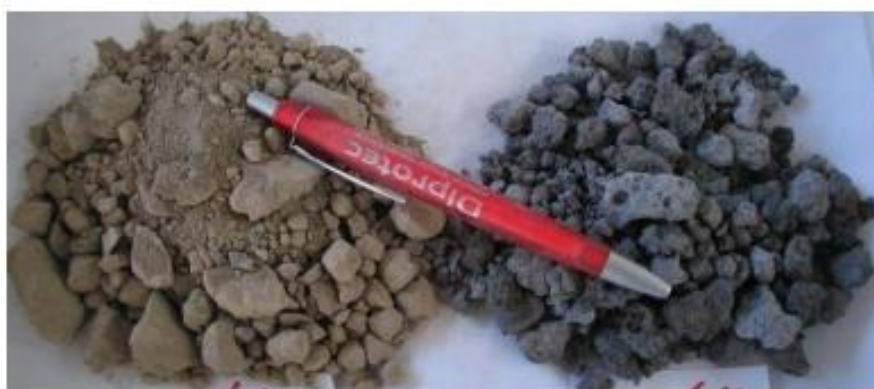
Figura 3.4. Amostras de escórias de LD e FEA. Fonte: (FREITAS, 2007).
