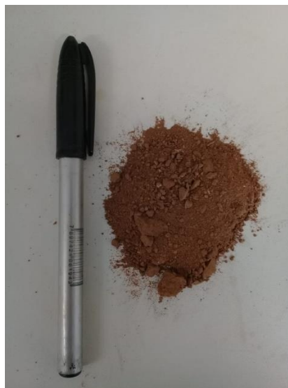
Figura 4.3. Amostra do solo coletado após remoção de cascalhos e matéria orgânica.
