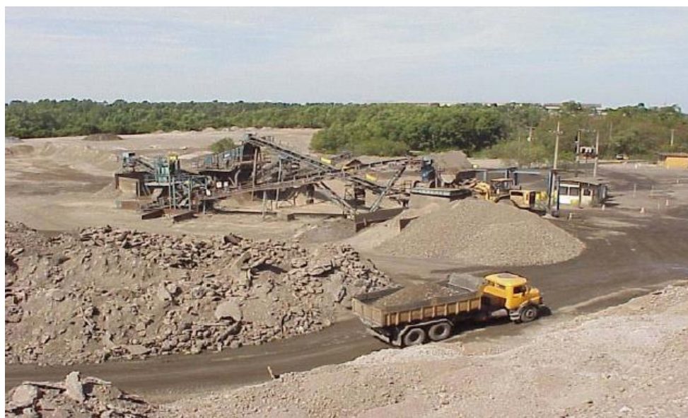
Figura 3.5. Uma típica planta de beneficiamento da escória. Fonte: (CST, 2006 apud SOUZA, 2007).
