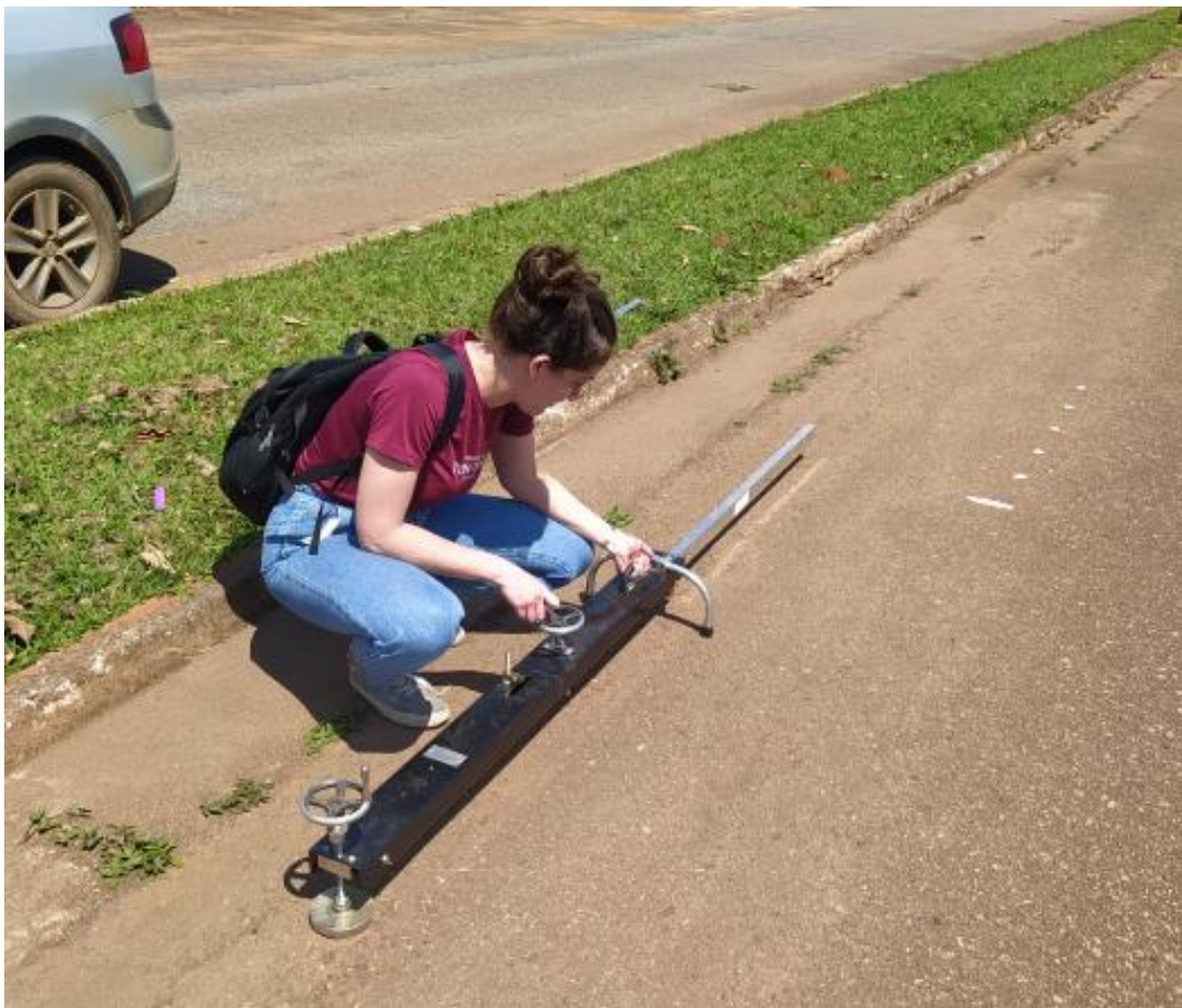
Figura 19 – Viga Benkelman em processo de montagem. Fonte: Arquivo pessoal.
