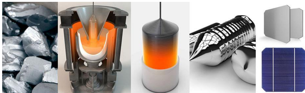
Figura 7: Processo de produção da Célula Mono-Si.
