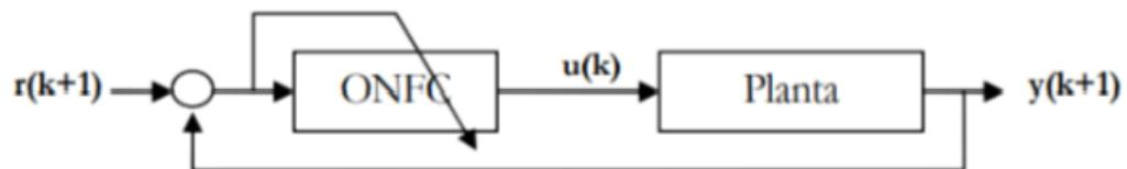
Figura 2.3.1 – Estrutura em diagrama de blocos de um processo controlador por ONFC.
