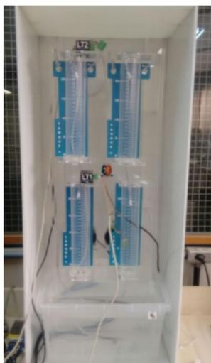
Figura 9 – Bancada de Tanques Acoplados. Fonte: (OLIVEIRA, 2017).
