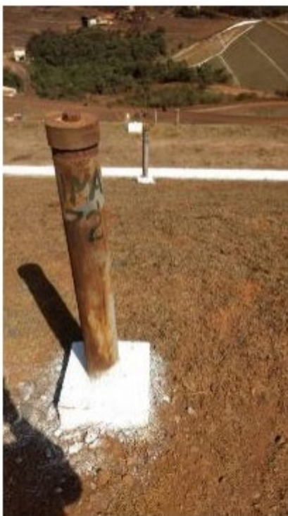
Figura 35 - Piezômetros e/ou medidores de nível de água e marcos superficiais instalados na Barragem B-I Mina Córrego Feijão.
