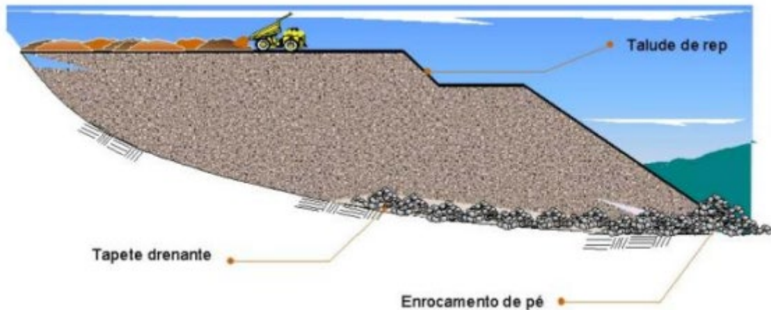
Figura 10 - Visão esquemática dos basculamentos consecutivos na disposição de estéréis em camadas.
