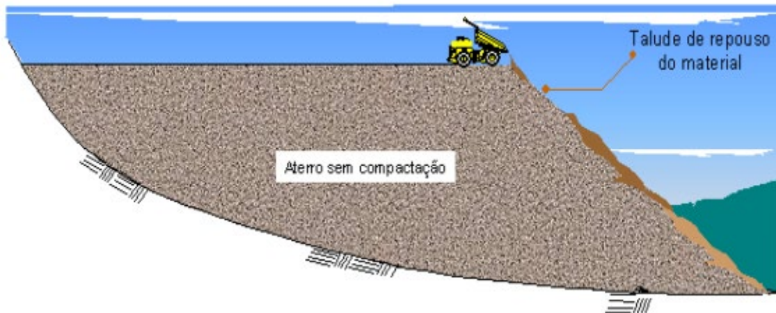
Figura 11 - Desenho esquemático da disposição de pilhas por banco ou em ponta de aterro.
