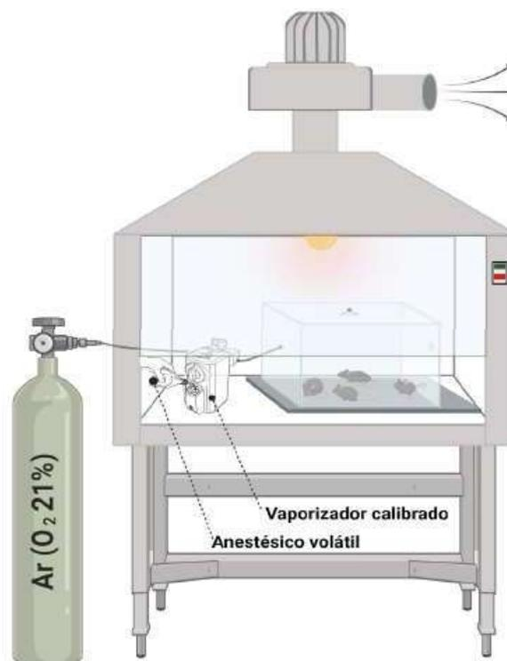
Esquema do aparato de exposição em capela de exaustão (Câmara de inalação - 40 cm de comprimento, 30 cm de largura e 25 cm de altura) (Fonte: adaptado de (MACHADO-JUNIOR; DE SOUZA; CASTRO; PERUCCI *et al.*, 2022).
