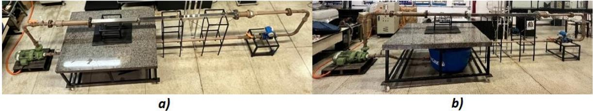
Figura 17 - Vistas a) superior e b) frontal da Bancada de Fluxo Experimental de Conduto Forçado (BFECF).
