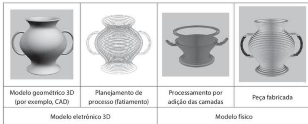
Figura 6 – Representação das principais etapas do processo de impressão 3D.
