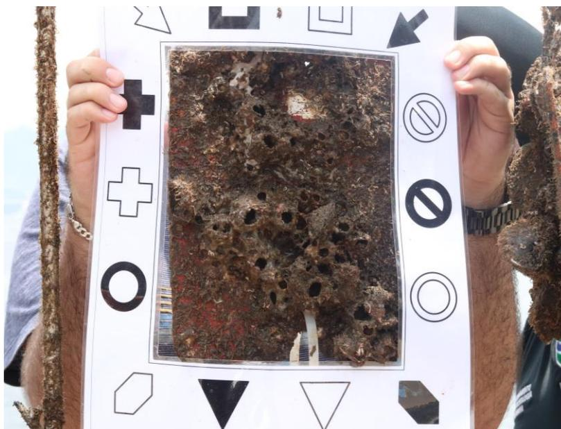
Figura 13 – Representação do procedimento utilizado para fotogrametria das placas com bioincrustações reais.
