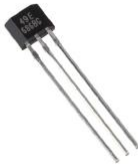
Figura 4 – Sensor de efeito hall Fonte: Gomes, 2018.
