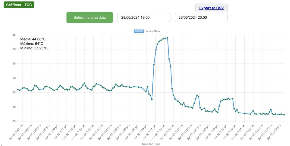
Figura 11 – Gráfico principal. O eixo X representa a data e hora (mês, dia, hora e minuto), e o eixo Y representa a temperatura em graus Celsius (Temperatura °C).
