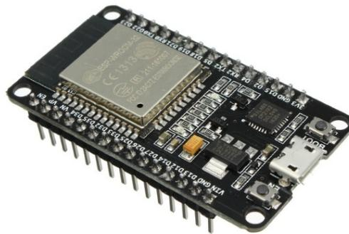
Figura 1 – Placa de desenvolvimento ESP-WROOM32-02. Fonte: ([ESPRESSIF SYSTEMS, 2024](#))
